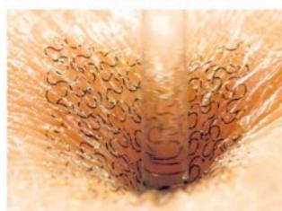
Le «patch», flexible, a la taille d'un timbre-poste et une épaisseur de 7 micromètres. L'adhésion à l'épiderme est réversible et n'entraîne pas d'irritation.
